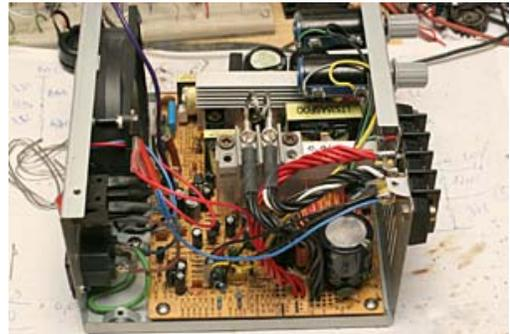
Con lo stesso schema è possibile realizzare un ottimo carica batterie per il 12V o anche per il 24V semplicemente montando all'interno due trimmer al posto dei potenziometri e tarando la tensione di uscita per 14,5Volt (29V) tensione che corrisponde a una batteria a fine carica.
